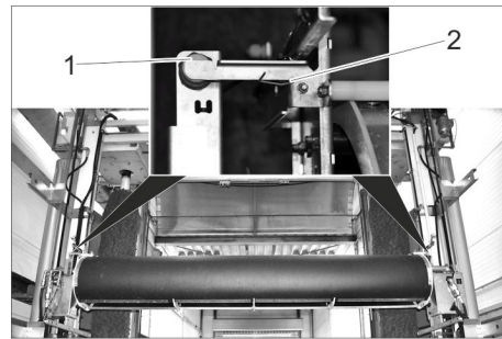
Obr. 8 1 Koncový spínač bezpečnostního vypínače vysokotlaké střešní lišty 2 Pružina
