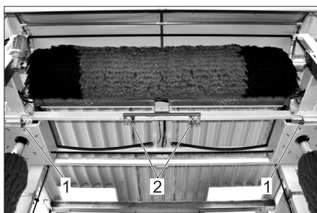
Obr. 6 1 Koncový spínač bočního kartáče vně 2 Koncový spínač bočního kartáče uvnitř
