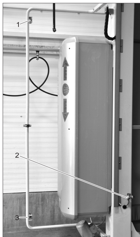
Obr. 2 1 Světelná závora poloha 2 nahore 2 Koncový spínač střešního kartáče dole (SKD) 3 Světelná závora poloha 2 dole
