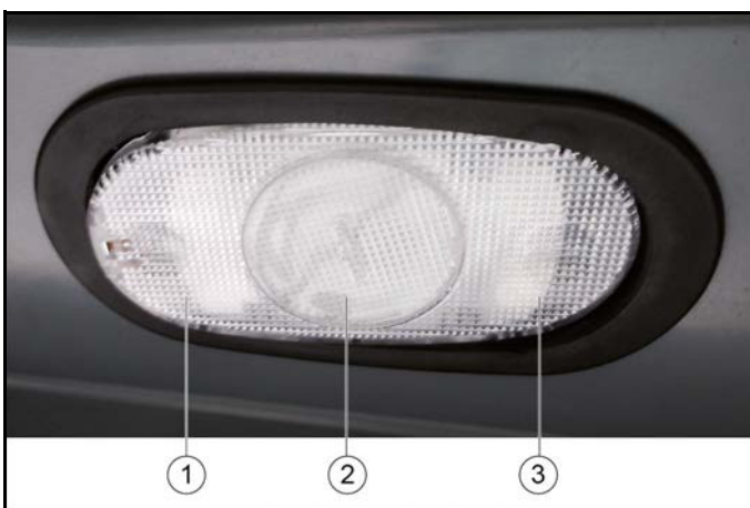
① Apăsat pe stânga: Iluminat conectat
