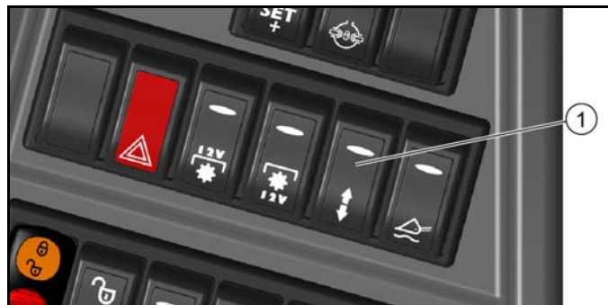
① Comutatorul „sistem hidraulic de comandă cu dublă acțiune AUX Spate / cadru de montaj cu funcție de rabatare”
