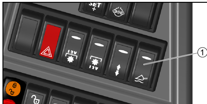
① Hauptschalter Schwimmstellung
